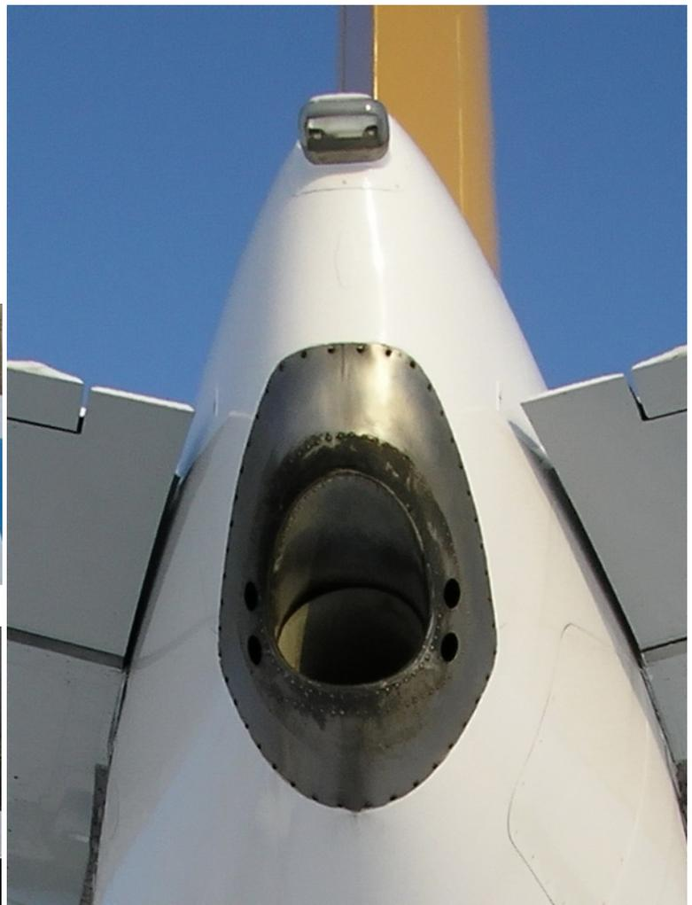
Рис. 80. Фюзеляжный хвостовой огонь.
