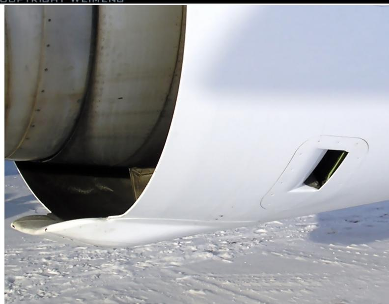
Рис. 24. Вентиляция на сдвижном капоте реверса.
