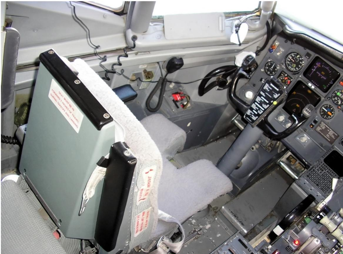
Рис. 129. Рабочее место командира воздушного судна.
