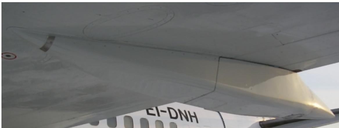
Рис. 5. Внешний обтекатель левого крыла.
