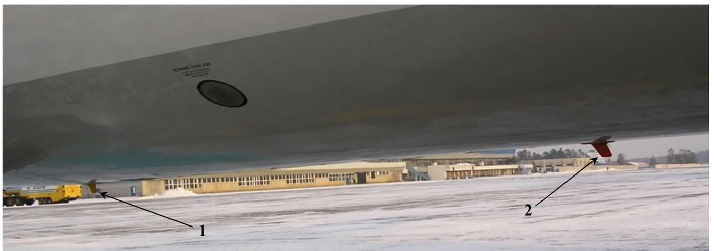
Рис. 92. Нижняя ненаправленная антенна TCAS и передняя антенна DME.
