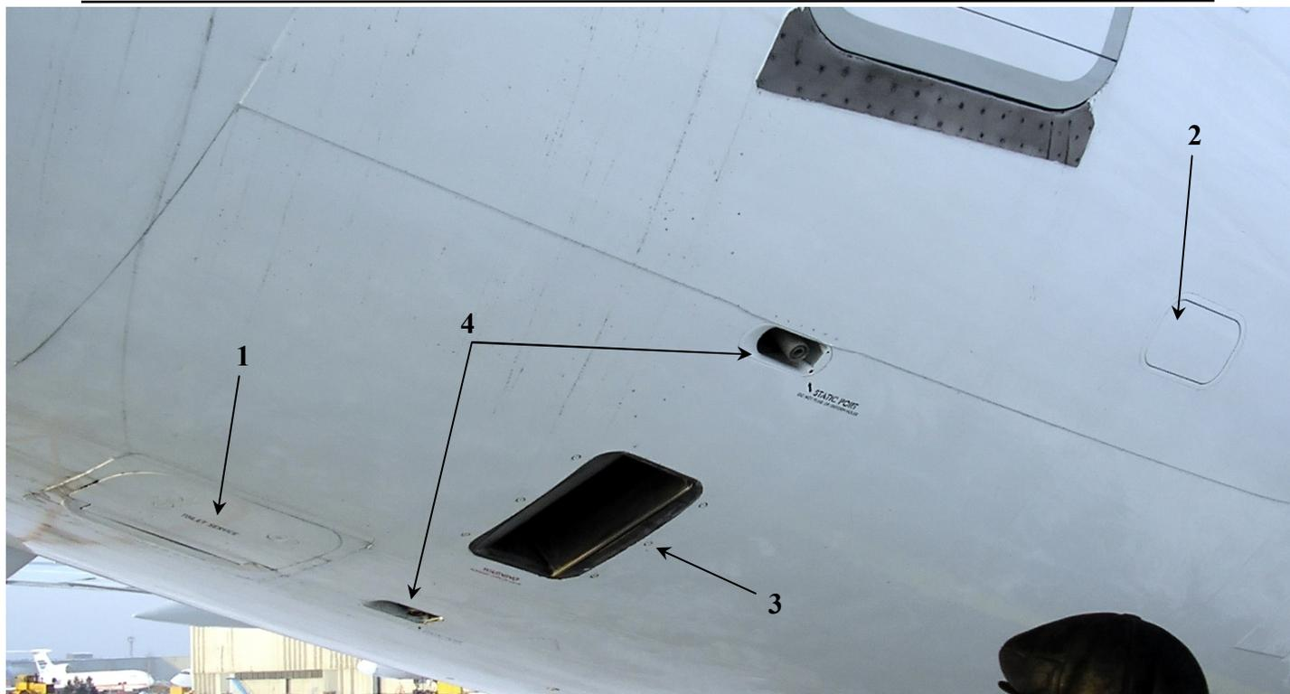
Рис. 109. Лючки в хвостовой части фюзеляжа, вид справа.
