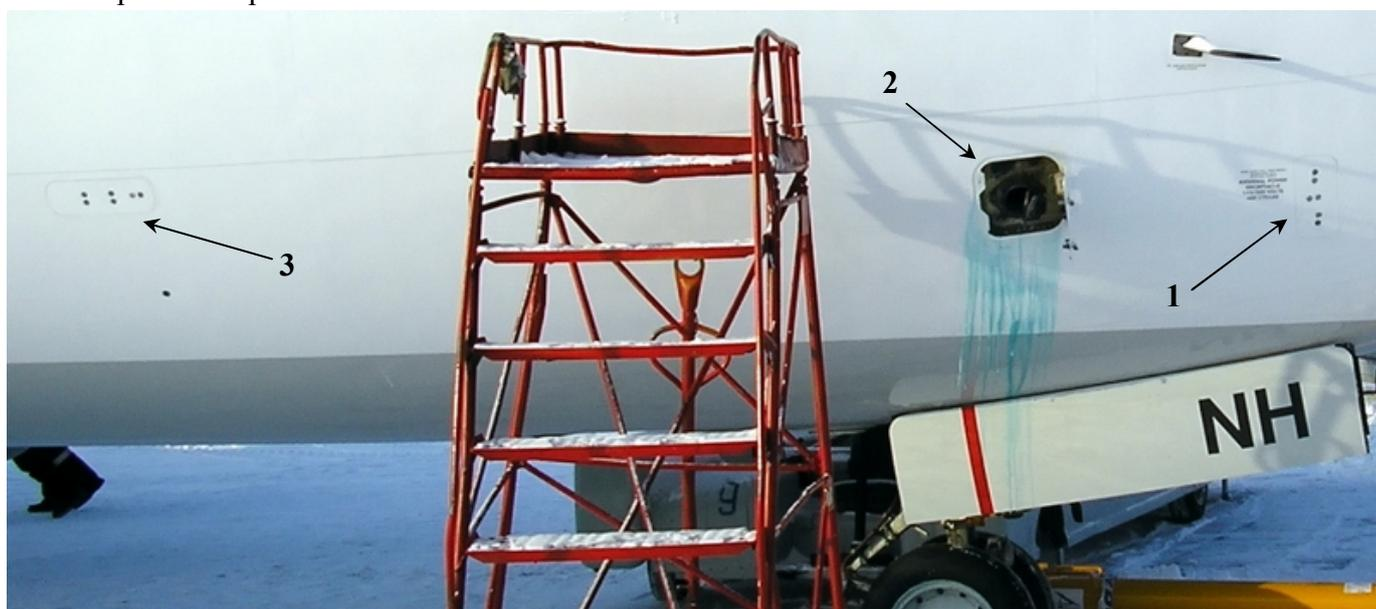
Рис. 112. Лючки на передней части фюзеляжа.
