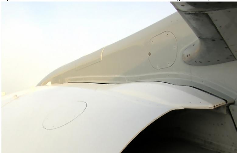
Рис. 16. Сопряжение пилона с крылом с внутренней стороны.
