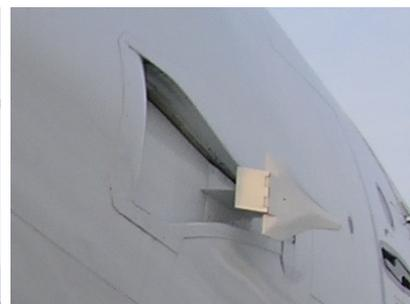
Рис.102. Воздухозаборник ВСУ, вид сзади.
