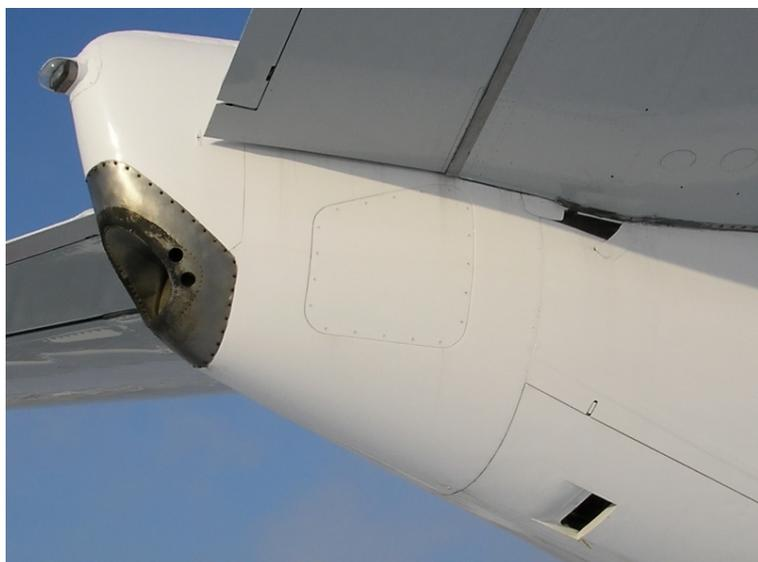
Рис.108. Лючок доступа в хвостовой конус
