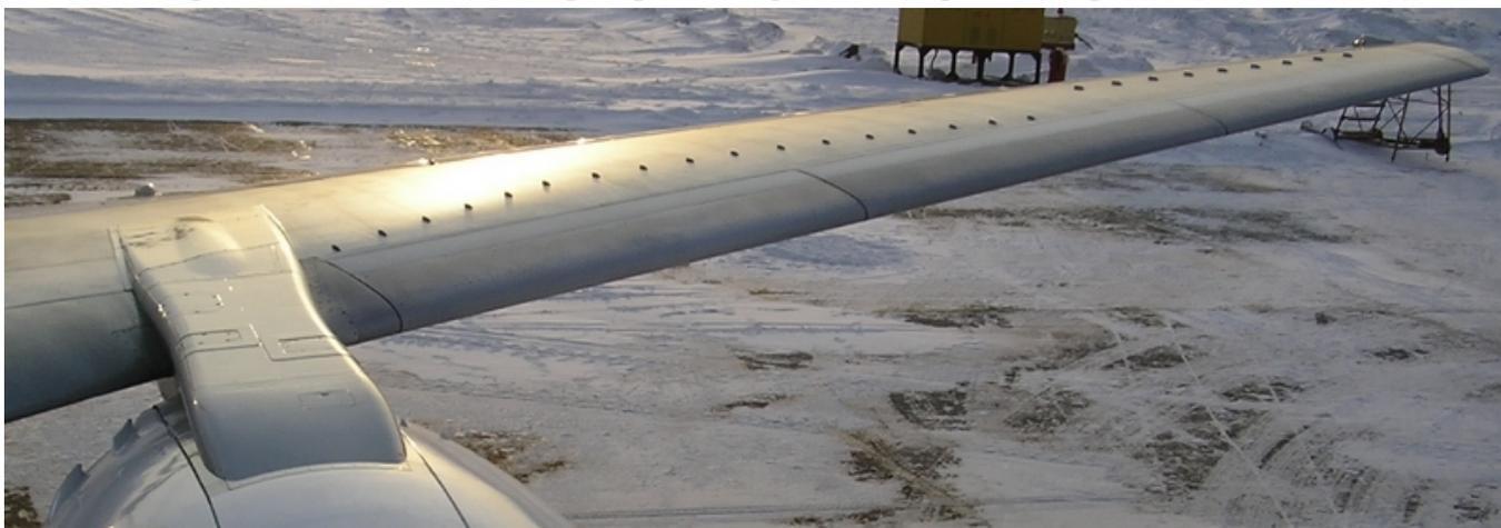
Рис.121. Генераторы вихрей на левом крыле.
