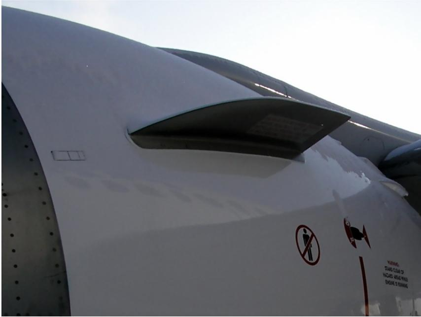
Рис. 18. Генератор вихрей (VORTEX CONTROL DEVICE) на правой мотогондоле.
