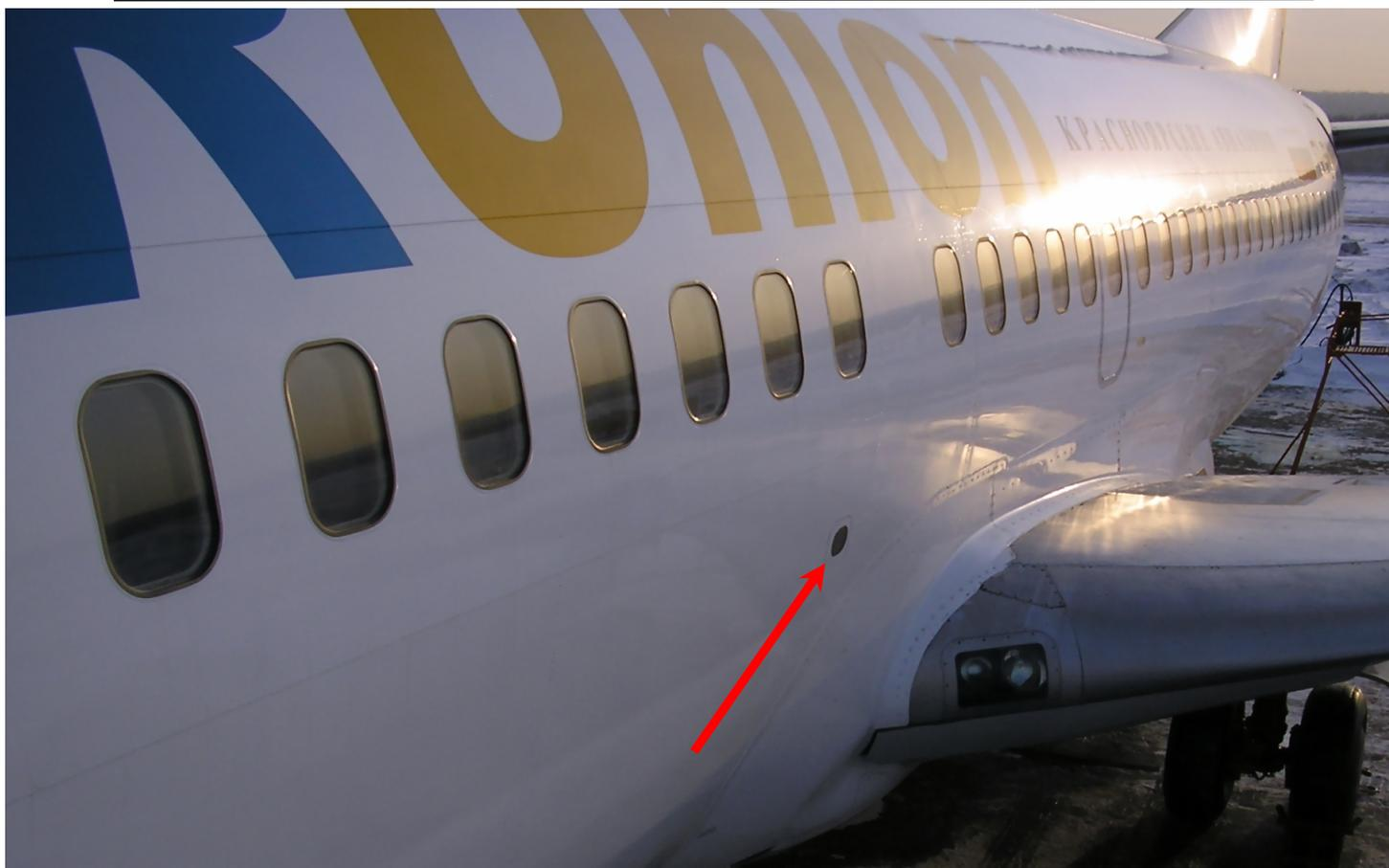
Рис.71. Иллюминаторы. Красная стрелка показывает на фару подсвета передней кромки крыла.
