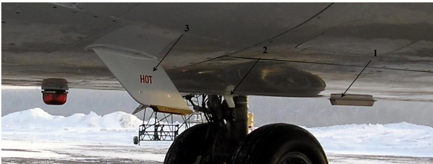
Рис. 89. Проблесковый маяк, сливной насадок, антенна маркерного радиоприёмника и задняя антенна радиодальномера.
