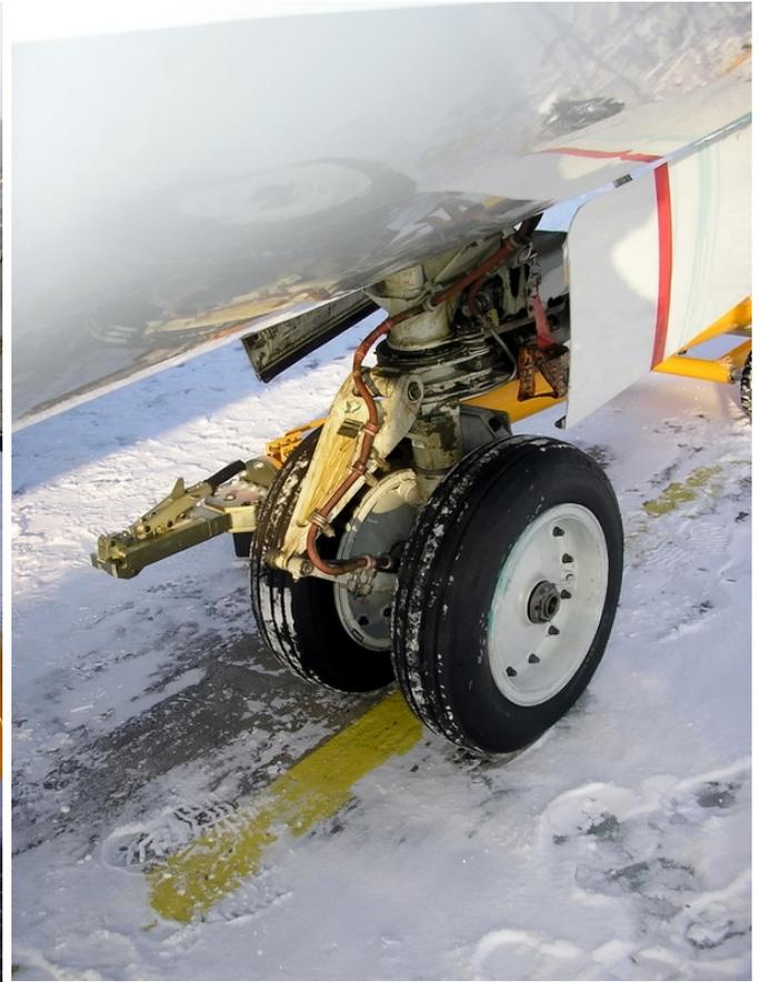
Рис.64. Передняя опора шасси, вид сзади.
