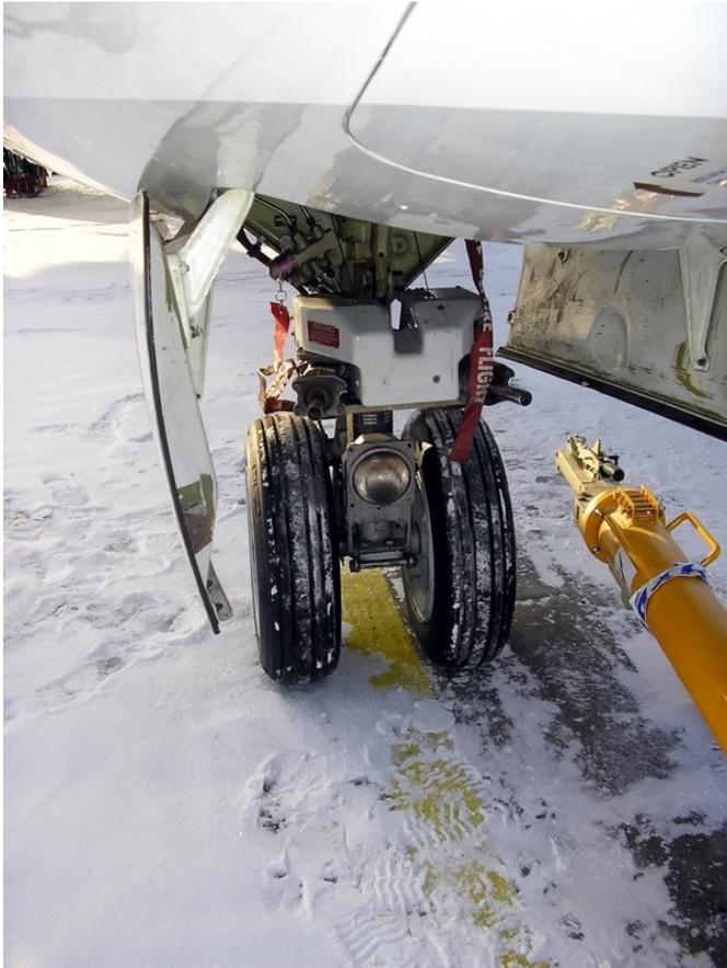
Рис. 63. Передняя опора шасси, вид спереди.
