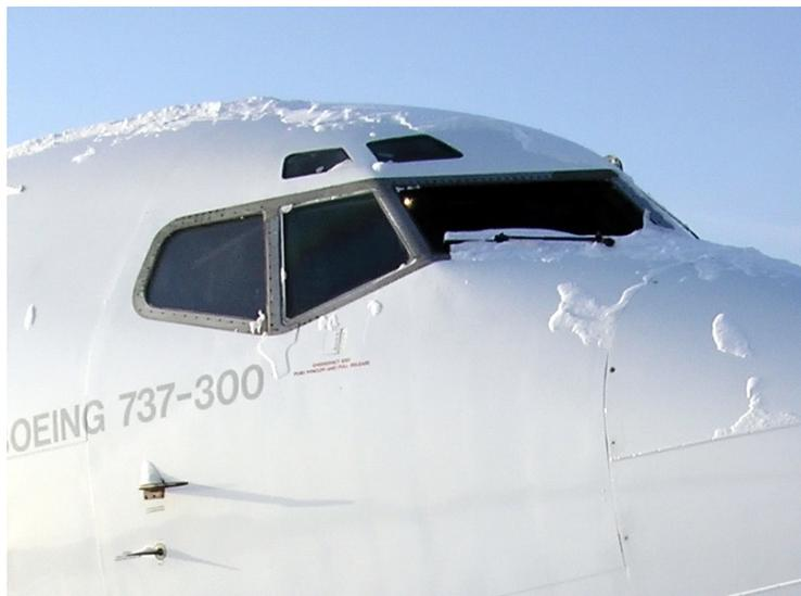
Рис. 68. Остекление кабины пилотов, вид справа.
