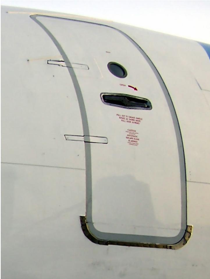
Рис. 39. Левая передняя входная дверь
