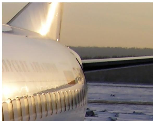
Рис.34. Выступ на фюзеляже в месте сопряжения со стабилизатором.
