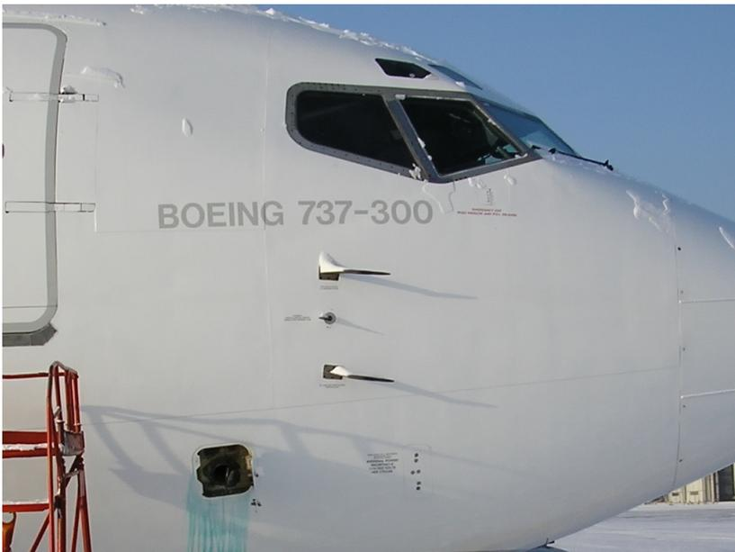
Рис. 95. Датчики на правой стороне фюзеляжа.
