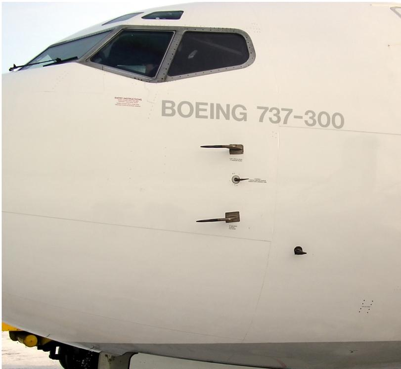
Рис. 93. Датчики на левой стороне фюзеляжа.
