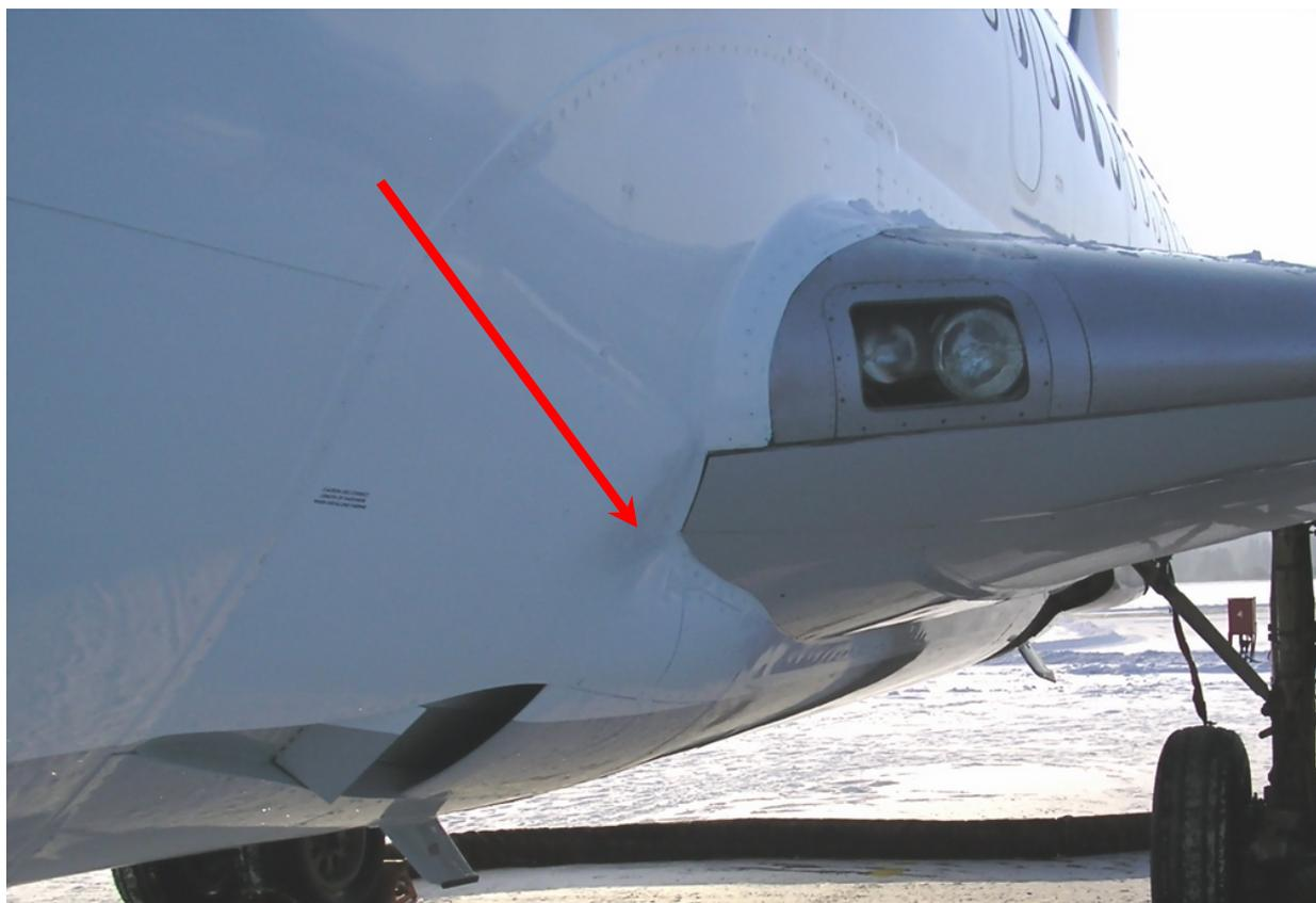
Рис.6 Передняя часть зализа левого крыла.
