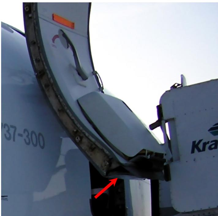
Рис. 40. Левая передняя входная дверь в открытом положении. Стрелка указывает на отклонённый нижний сегмент двери.
