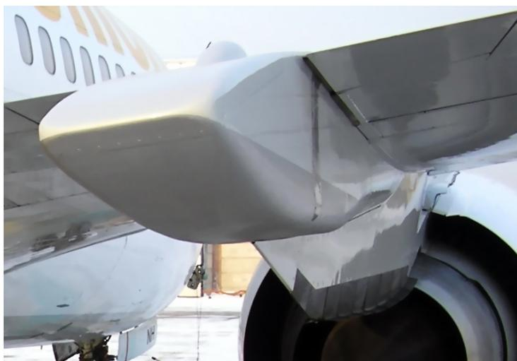
Рис. 13. Обтекатель, вид сзади.
