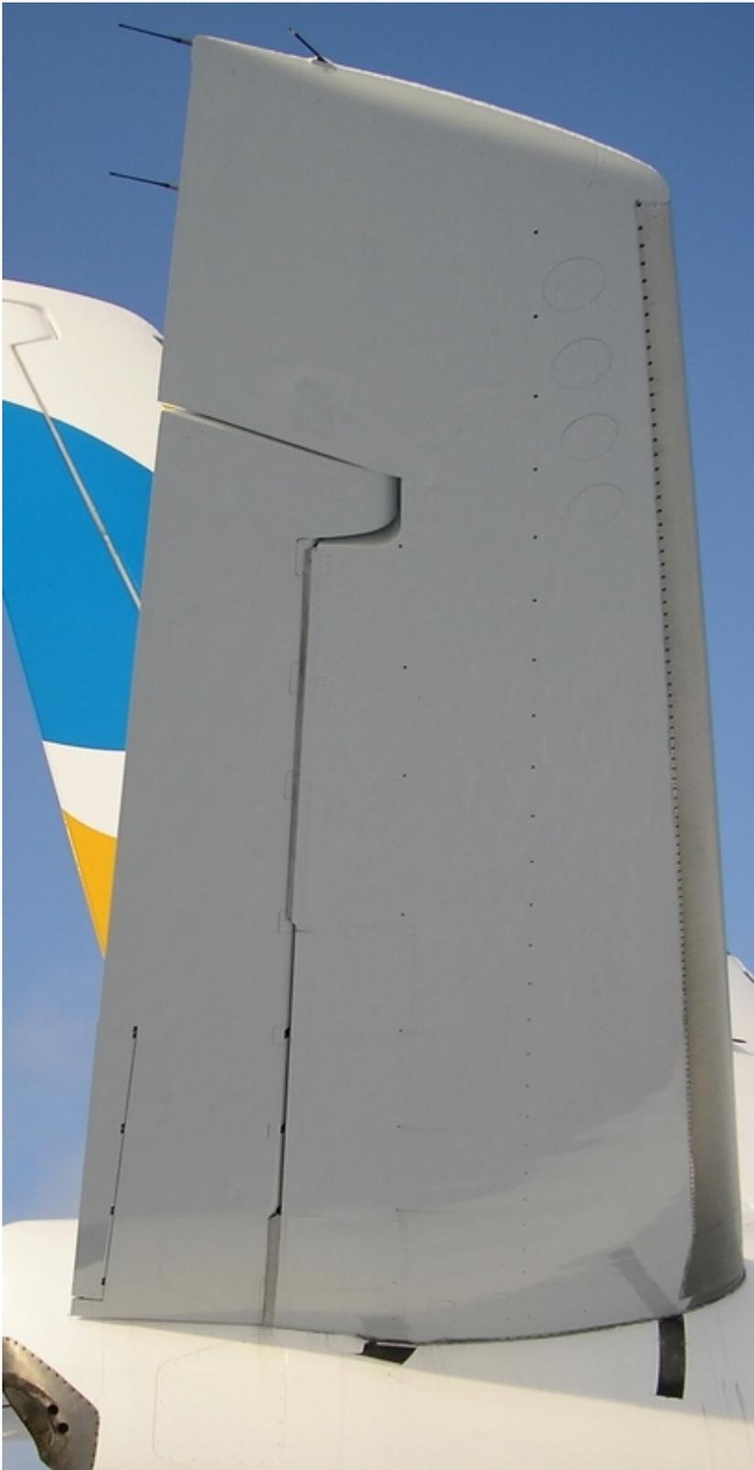
Рис.35. Вид снизу на левую половину стабилизатора.
