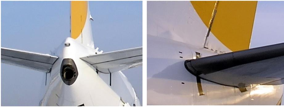
Рис. 124 и 125. Генераторы вихрей на хвостовом конусе.
