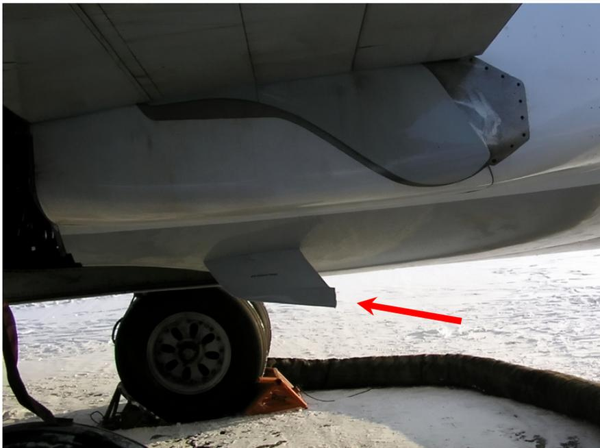
Рис. 57. Внутреннее колесо правой основной опоры шасси. Красная стрелка показывает на сливной насадок дренажа топливной магистрали ВСУ.
