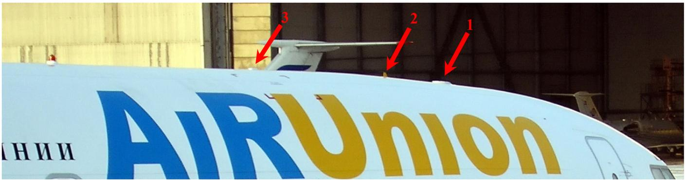
Рис.90. Антенны на верхней части фюзеляжа.
