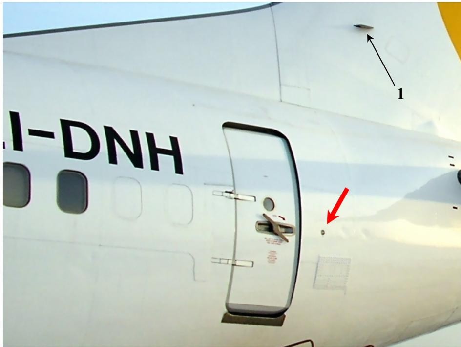
Рис. 41. Левая задняя входная дверь. Красная стрелка указывает на фара подсвета аварийного выхода.
