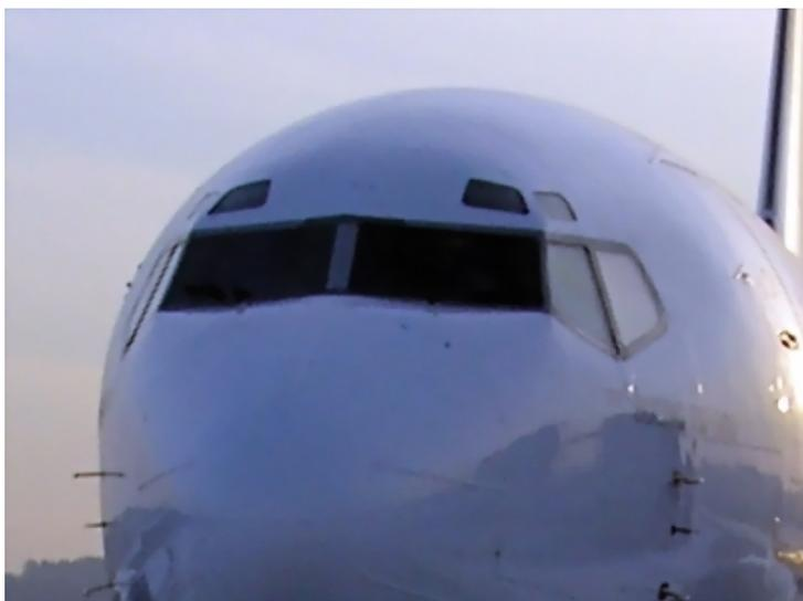
Рис. 70. Остекление кабины пилотов, вид спереди
