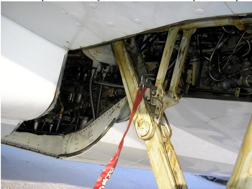
Рис. 56. Замок выпущенного положения основной опоры.
