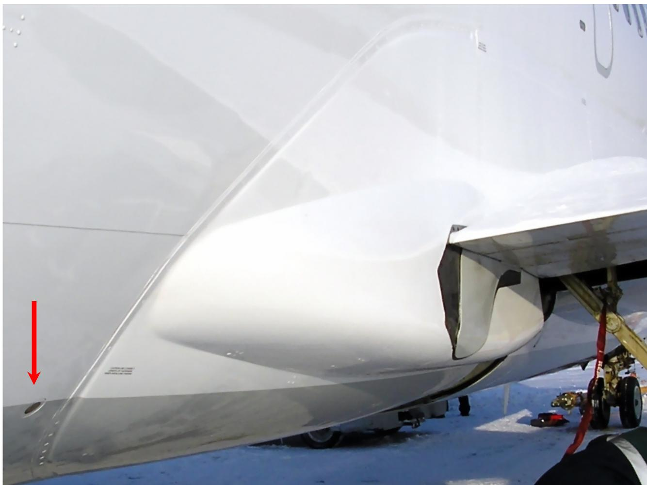
Рис. 8. Задняя часть зализа правого крыла. Стрелкой показан фонарь подсвета пути аварийного спуска с крыла.
