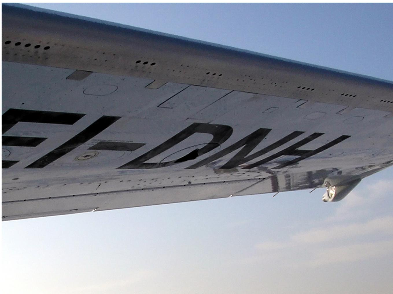
Рис.116. Воздухозаборник дренажа и предохранительный клапан дренажного бака на левом крыле.
