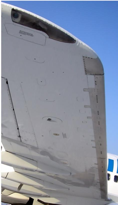
Рис. 29. Предкрылок правого крыла, вид снизу.
