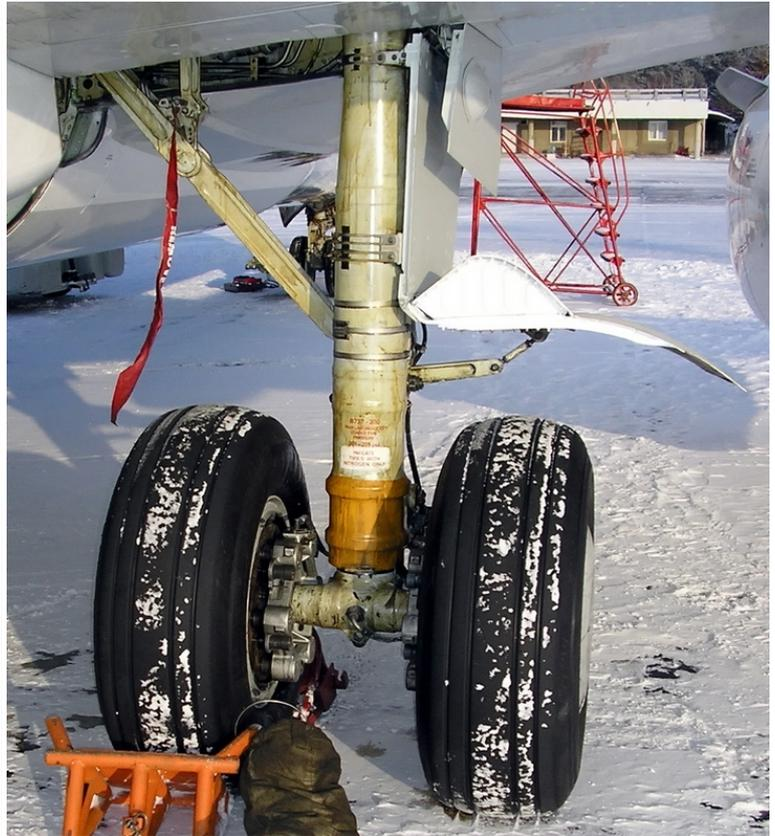
Рис.55. Правая основная опора, вид сзади.
