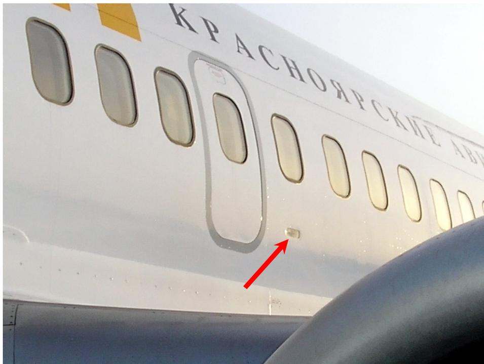
Рис. 50. Люк аварийного выхода на левое крыло.
