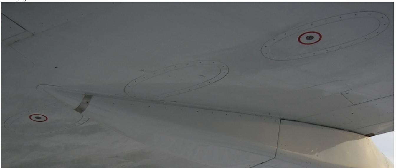
Рис.114. Лючки доступа в топливные баки.
